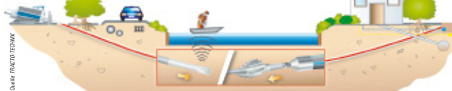
Horizontales Spülbohrverfahren im Querschnitt: Bevor die Leitungen eingezogen werden, streckt man sie an der Straße entlang vor. Bei dem horizontalen Spülbohrverfahren wird der Bohrkopf in das Erdreich gedreht. Die Bohrungen müssen permanent überwacht, präzise gesteuert und geortet werden.
