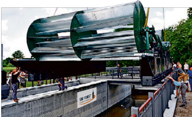
Neben den kommunalen Wasser- und Abwasserbetrieben stellen sich auch etliche Stadtwerke der Herausforderung zur verstärkten Nutzung Erneuerbarer Energien. Die Stadtwerke Forst beispielsweise kooperieren mit dem „Netzwerk Technologiekompetenz Fluss-Strom“ und testen einen „River Rider“ als schwimmendes Kraftwerk zur Energieerzeugung in der Neiße-Strömung.
