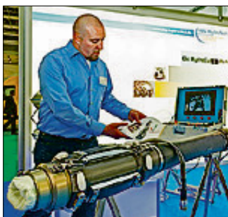
Der Clou der Firma IGB Hydro Tech: Bei der Hausanschlusssanierung vom Hauptkanal aus muss das Privatgrundstück nicht betreten werden. Foto: SPREE-PR/Petsch
