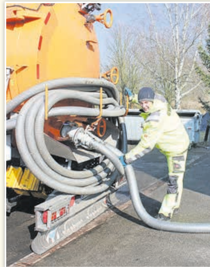
Detlef Gewiese am Spezialfahrzeug für die Fäkalienentsorgung. Über die Schläuche werden die Sammelgruben und Kleinkläranlagen abgepumpt.
