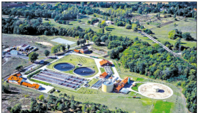
An die Abwasserbehandlungsanlage Gubin / Guben – wie sie offiziell heißt – sind mehr als 40.000 Menschen angeschlossen. Jährlich reinigt die Anlage rund 3 Mio. m 3 Abwasser. Mit der Anlage wird die Schadstoffbelastung der Neiße jährlich um rund 265 Tonnen Stickstoff und 50 Tonnen Phosphor reduziert. Damit leistet sie einen herausragenden Beitrag für den Schutz der Umwelt in der gesamten Neiße-Region.
